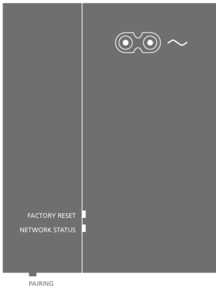
当您长按配对按钮 1.5 秒时，按钮位于电视底部，您可以打开电视进行遥控器配对。要取消配对模式，再次按下按钮。
