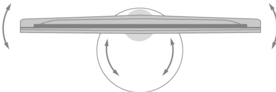
1. 在**待机调节**菜单中，使用 **<** 和 **>** 通过落地脚架的管子转动电视机，使用 **^** 和 **v** 通过落地脚架的基座转动电视机。电视机必须与背后的墙壁保持平行。
