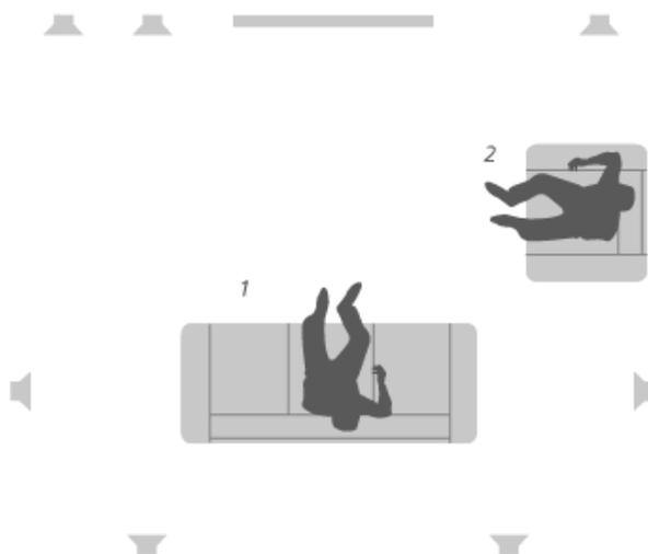
在图例的场景 1 中，当您在沙发上看电视时，可以将顶部的右侧扬声器设为右侧前置扬声器，在场景 2 中，当您坐在扶手椅上听音乐时，该扬声器可用作右侧环绕扬声器。同一扬声器在不同的扬声器群组中有不同的作用，在某些扬声器群组中，可能不包含该扬声器。
