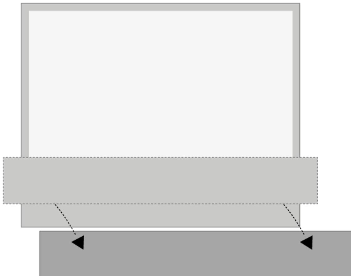
进行清理时，建议取下扬声器封盖。不要直接对屏幕喷射液体，因为这可能会损坏扬声器，请改用软布。在侧面和底部撑住扬声器封盖，小心将其取下。
