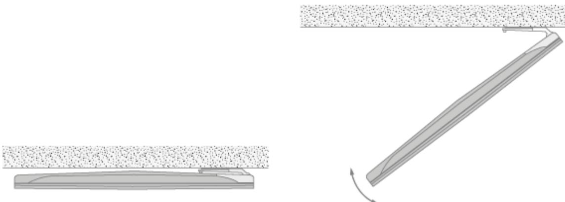
设置打开机动落地脚架或墙托架的最大角度。切记，请在电视机周围留下足够的空间，以便可以自由转动。更多信息，请参阅文章“脚架设置”。
